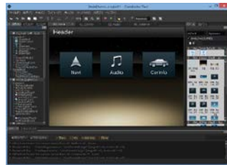
UI コンダクター Tact (オーサリングツール) 上で HMI コンテンツを作成
